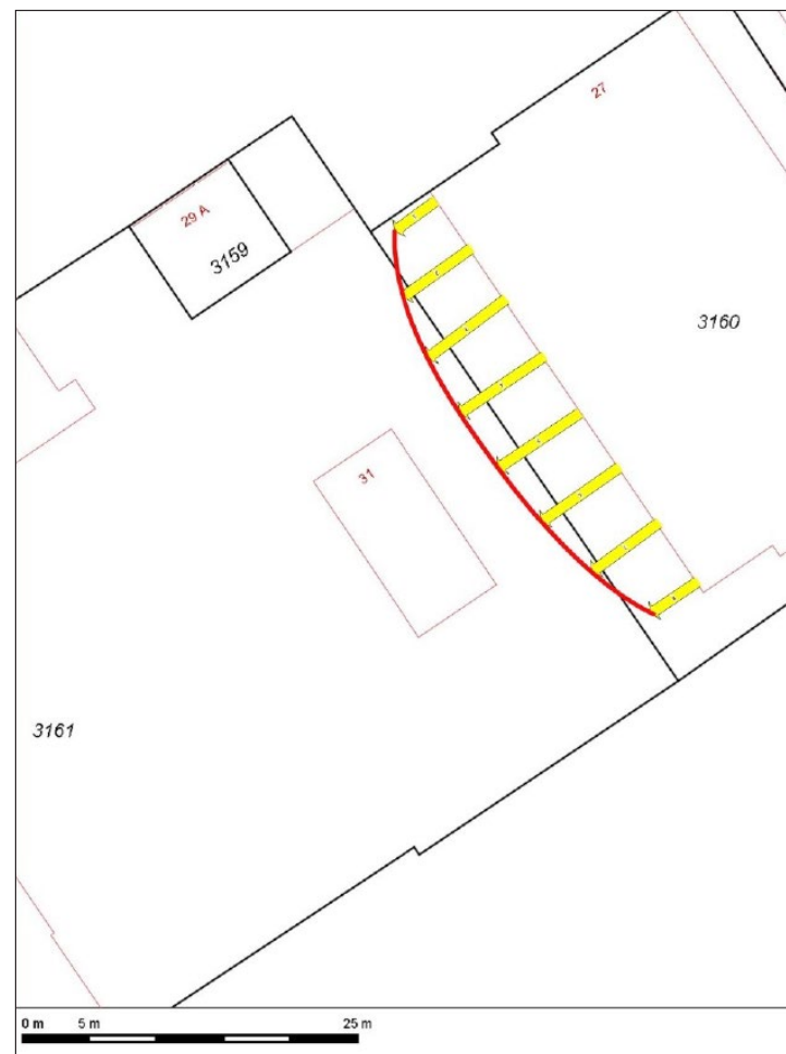
De berekende 0,4 microtesla magneetveldcontour van het onderstation
